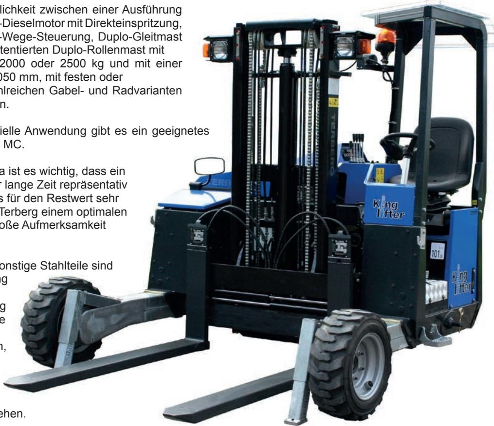
Alle Modelle sind mit Arbeitsbeleuchtung, Rundumkennleuchte, Feststellbremse und Servolenkung versehen.
